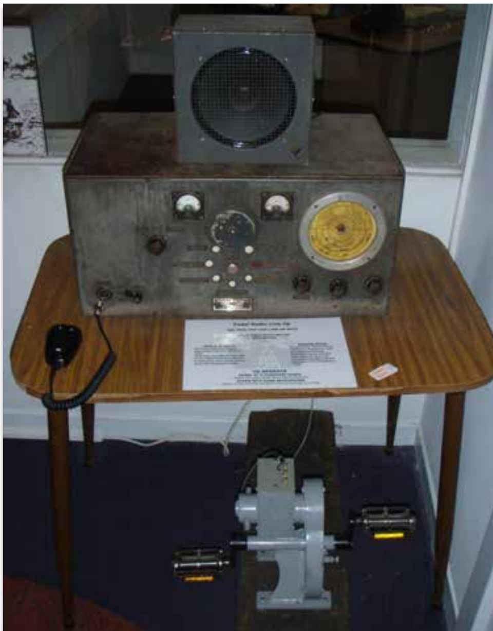
Pedal radio station of the Aerial Medical Service (used for radio Teleconsultations), Australia, 1930s Педальная радиостанция Авиационной медицинской службы (использовалась для радио телеконсультаций), Австралия, 30-е годы XX века
