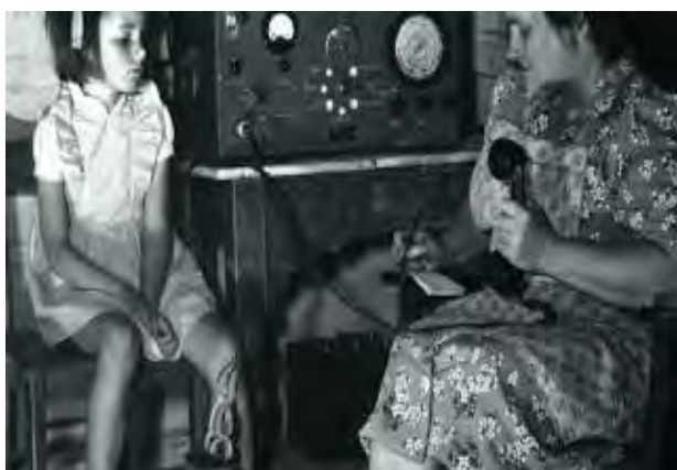
Pedal radio station of the Aerial Medical Service (used for radio Teleconsultations), Australia, 1930s Педальная радиостанция Авиационной медицинской службы (использовалась для радио телеконсультаций), Австралия, 30-е годы XX века
